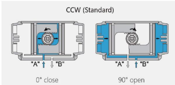
A口进气, 压缩空气推动活塞向外运动, 使执行器输出轴逆时针旋转(0°→90°), B口排气。B口进气, 压缩空气推动活塞向内运动, 使执行器输出轴顺时针旋转(90°→0°), A口排气。
