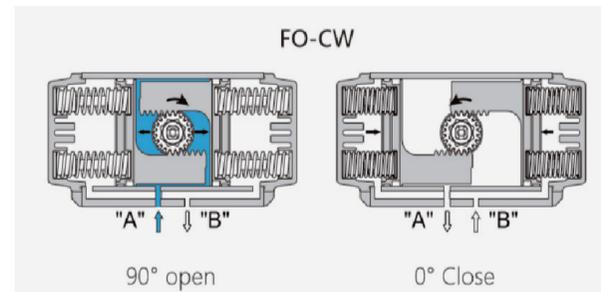
A口进气,压缩空气克服弹簧力, 推动活塞向外运动, 执行器输出轴顺时针转动(90°→0°), B口排气; 执行器失气, 活塞在弹簧力的作用下向内运动, 执行器输出轴逆时针转动(0°→90°), A口排气。
