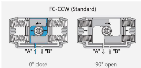
A口进气,压缩空气克服弹簧力, 推动活塞向外运动, 执行器输出轴逆时针转动(0°→90°), B口排气; 执行器失气, 活塞在弹簧力的作用下向内运动, 执行器输出轴顺时针转动(90°→0°), A口排气。
