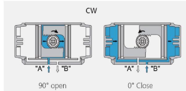
A口进气, 压缩空气推动活塞向外运动, 使执行器输出轴顺时针旋转(90°→0°), B口排气。B口进气, 压缩空气推动活塞向内运动, 使执行器输出轴逆时针旋转(0°→90°), A口排气。
